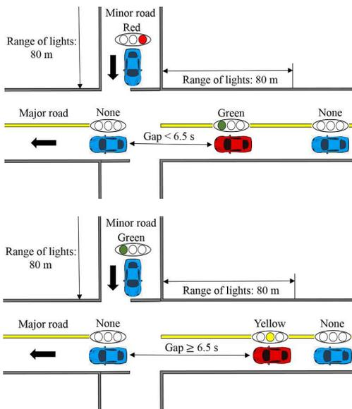
①優先道路を走行する車が車内信号の表示範囲に入ると、ドライバに青信号を表示する。非優先道路を走行する車に対しては、表示範囲に入る時から停止線で停車するまで赤信号を表示する。
